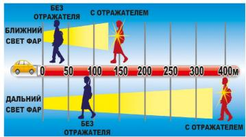
«Работает» светоотражатель просто. попадает Когда свет на светоотражающий элемент, он почти возвращается обратно полностью источнику. Источником может быть свет фар автомобиля или электрический фонарь, именно поэтому спектр использования светоотражателя очень широк: производство автомобильных дорожных И знаков. разметки, значков, брелоков, дорожной наклеек для пешеходов, велосипедистов, роллеров и прочих участников дорожного движения.
